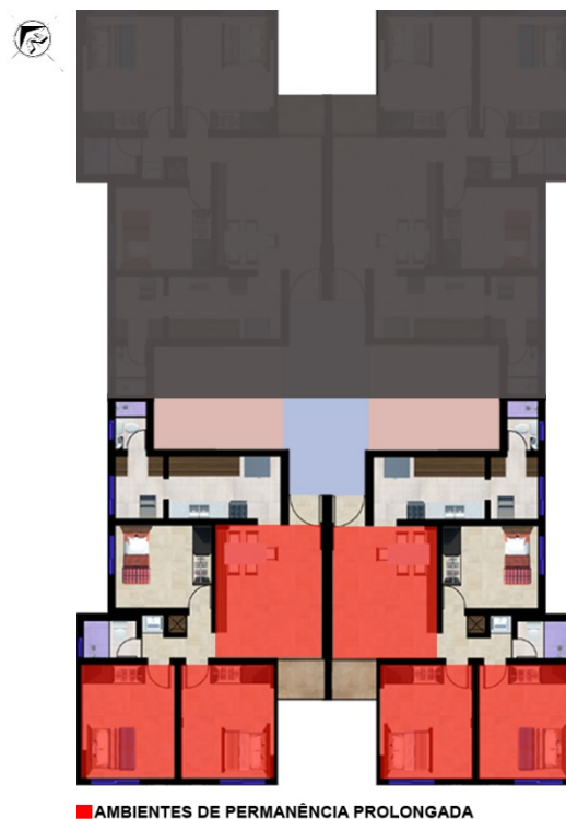
Fig. 37- Ambientes de permanência prolongada, fachada Sudoeste. Fonte: Autora, 2017.
